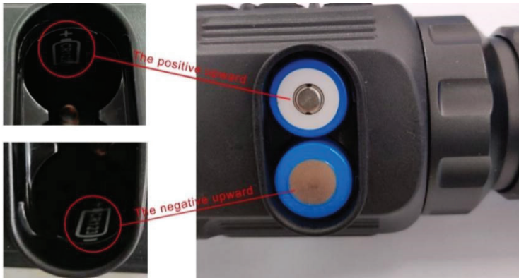
Zdj. 8-1 Schematyczny diagram instalacji baterii
