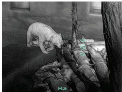
Zdj. 6-3 Interfejs korekcji uszkodzonych pikseli
